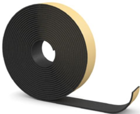
Лента самоклеящаяся Energocell® HT из вспененного эластомера (EPDM) обладает низким коэффициентом теплопроводности ( $\lambda_{40} = 0,042$  Вт/(м·°С) и предназначена для изоляции фитингов, арматуры и труднодоступных участков трубопроводов в системах отопления, а также для уплотнения различных соединений.
